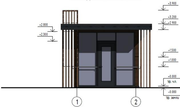
Фасад в осях 2-1 М1:50
